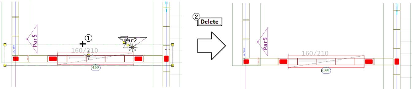
1. Clique com o mouse sobre a poligonal da cerca de parede
