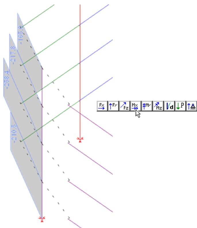
Durante o dimensionamento automático dos núcleos rígidos efetuado pelo TQS-Pilar, estes esforços (momentos torsores) são convertidos em esforços normais adicionais (força normal e momentos fletores) nas faixas, de acordo com o modelo local utilizado para calcular a inércia à torção equivalente.
