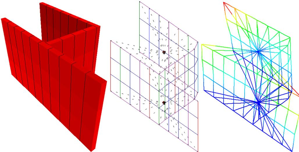
Este modelo é utilizado para calcular o valor de inércia à torção equivalente a ser adotada na barra que representa o pilar no pórtico espacial do edifício, com o objetivo de simular a flexo-torção efetiva deste elemento. Trata-se de um processo aproximado.
