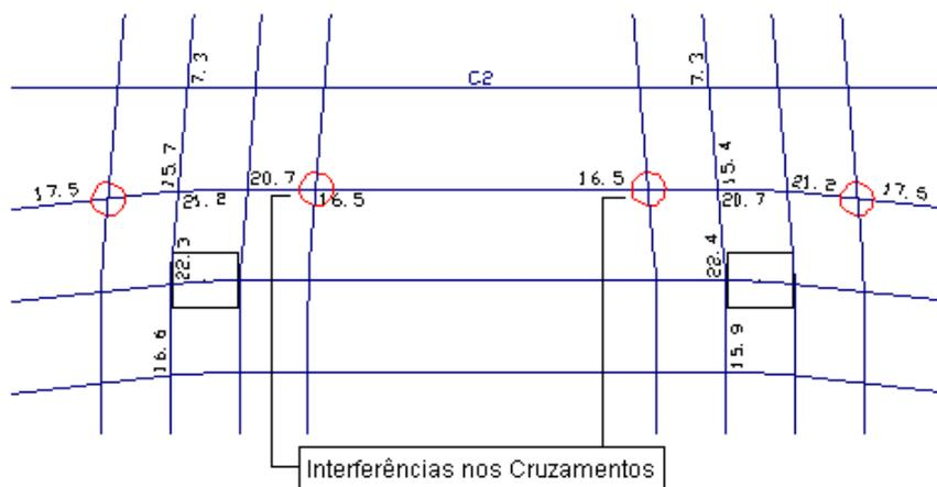
Caso você resolva eliminar as interferências alterando o desenho dos cabos em elevação, você deverá refazer o detalhamento das RPUs alteradas e regenerar o desenho de cabos.
