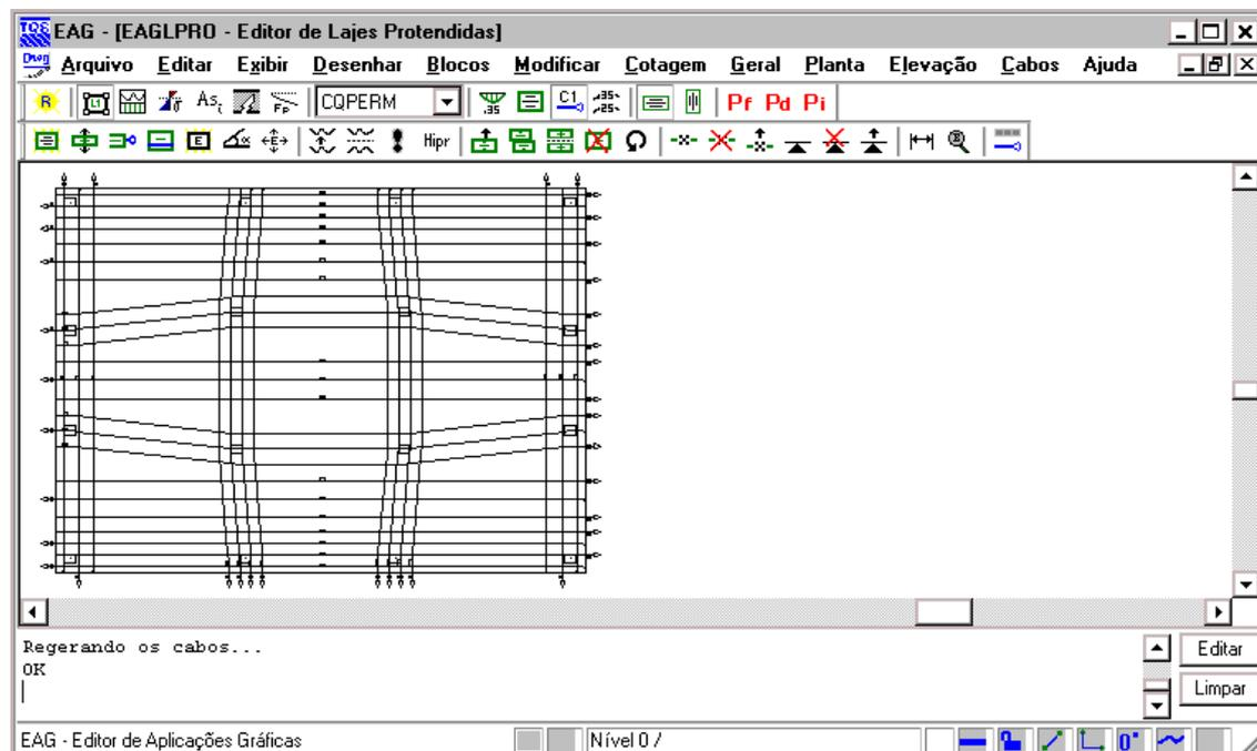
Os cabos podem ser gerados automaticamente, depois de terminado o detalhamento das RPU's, através do comando "Cabos" - "Gerar todos os cabos".
