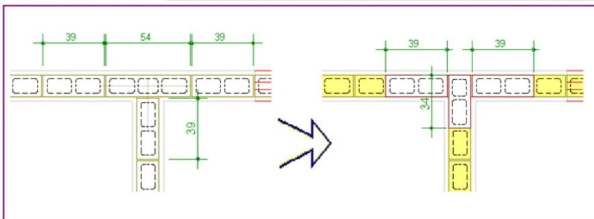
No primeiro exemplo que vamos ilustrar, vamos perceber que não existe a necessidade de distribuir os blocos da segunda fiada quando a primeira fiada segue a modulação “padronizada”, note que a parede Par5 modulada na entrada gráfica de alvenaria em planta no Alvest tem o desenho de elevação com a modulação das demais fiadas gerada automaticamente pelo Sistema:
