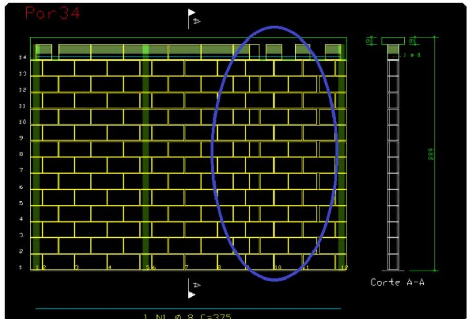
São estes os casos onde o Engenheiro Projetista precisa intervir na entrada gráfica de alvenaria em planta do Alvest, esta intervenção consiste em inserir alguns blocos na modulação da segunda fiada da entrada gráfica de alvenaria em planta:
