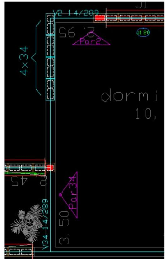
Como resultado final, teremos o desenho de elevação da Parede Par34 com a amarração dos blocos das fiadas ímpares e pares ao longo da elevação da parede, note que os blocos que já estavam distribuídos na fiada ímpar continuam na entrada gráfica sob os blocos de fiada par:
