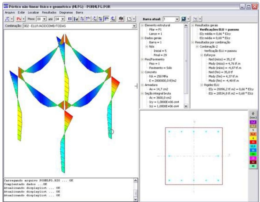
A rigidez EI adotada em cada trecho dos pilares foi calculada levando-se em consideração a variação de seção e as reais armaduras detalhadas. Veja, a seguir, um exemplo do cálculo a partir de diagramas N, M, 1/r (superfície N, M, 1/r).
