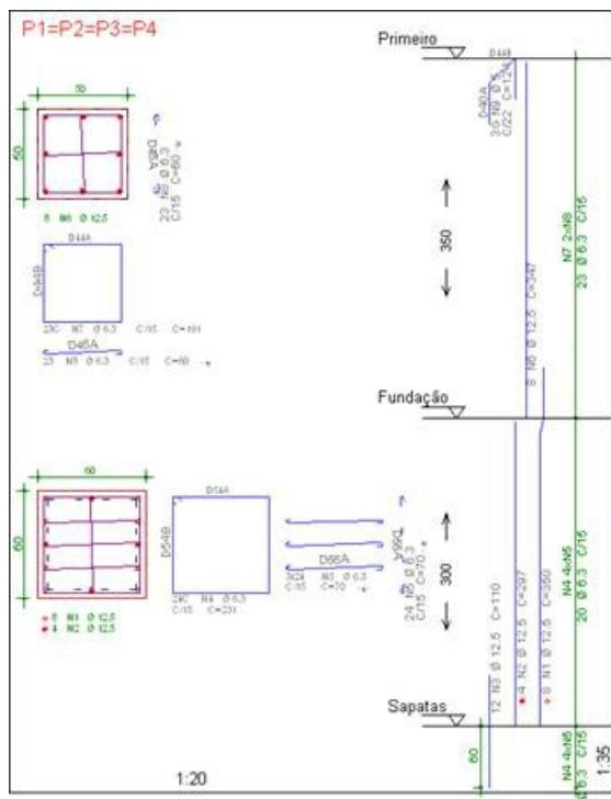
O dimensionamento das armaduras dos pilares levou em consideração a variação de seção, pé-direito de 6,25 m (6,5 –  $\frac{1}{2}$  da altura da viga de 50 cm) e apoios articulados no topo e na base (bi-rotulado). Isso fica claro ao checar o relatório de montagem de carregamentos do TQS-Pilar, parcialmente mostrado abaixo.
