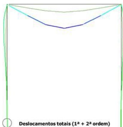
No visualizador de Pórtico NLFG, é possível avaliar o ELU à flexão composta oblíqua nas vigas e nos pilares de modo fácil.
