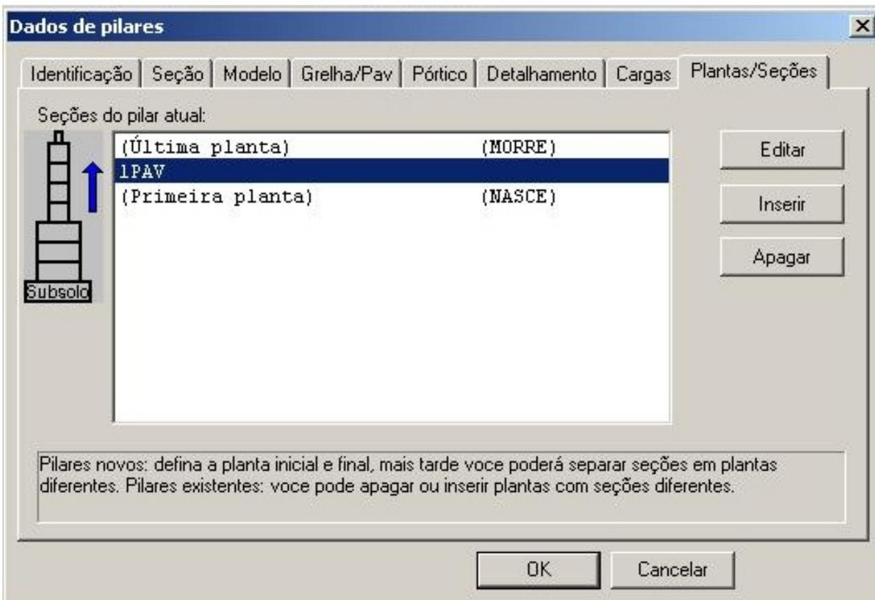
No nosso exemplo, criei uma variação abaixo do pavimento 1PAV. Depois vamos para a aba Detalhamento e definimos o cobrimento para o novo trecho:
