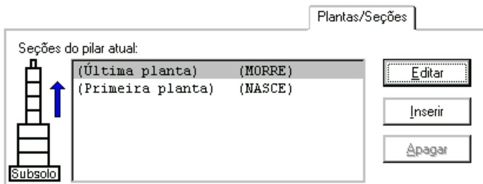
A partir daí, foi necessário estabelecer a partir de qual pavimento o pilar P8 ganharia uma variação de seção, (estas variações geralmente ocorrem para uma seção menor conforme "subimos" na edificação).
