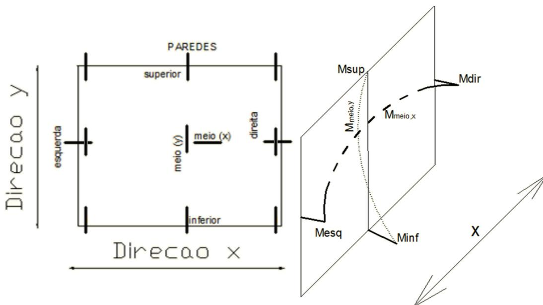
Adiciona-se o esforço normal médio, para o caso do modelo simplificado, ou toma-se o esforço normal do elemento, no caso dos outros dois modelos, de modo a se obter o maior valor de armadura necessária.
