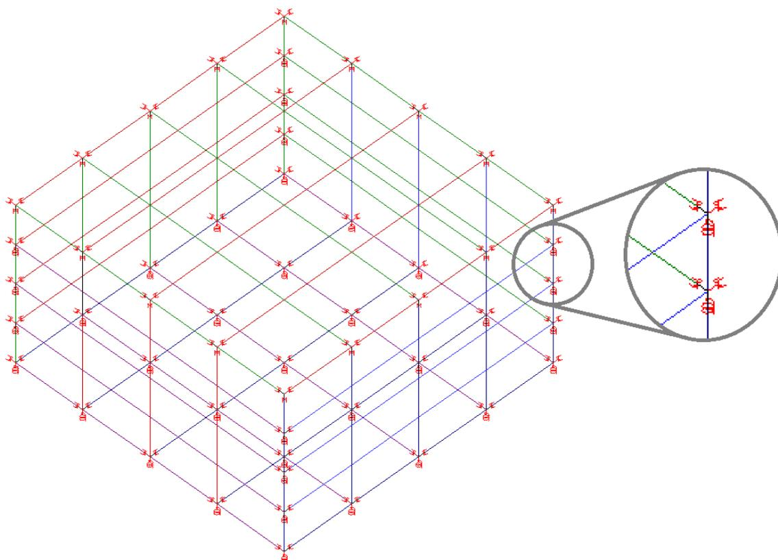
Neste caso, as restrições de apoio restringem a translação e rotação nas três direções.
