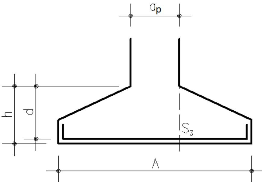
O esforço para cálculo da tensão cisalhante é calculado levando-se em conta o diagrama de tensões no solo, entre a seção  $S$  e a extremidade da sapata.
