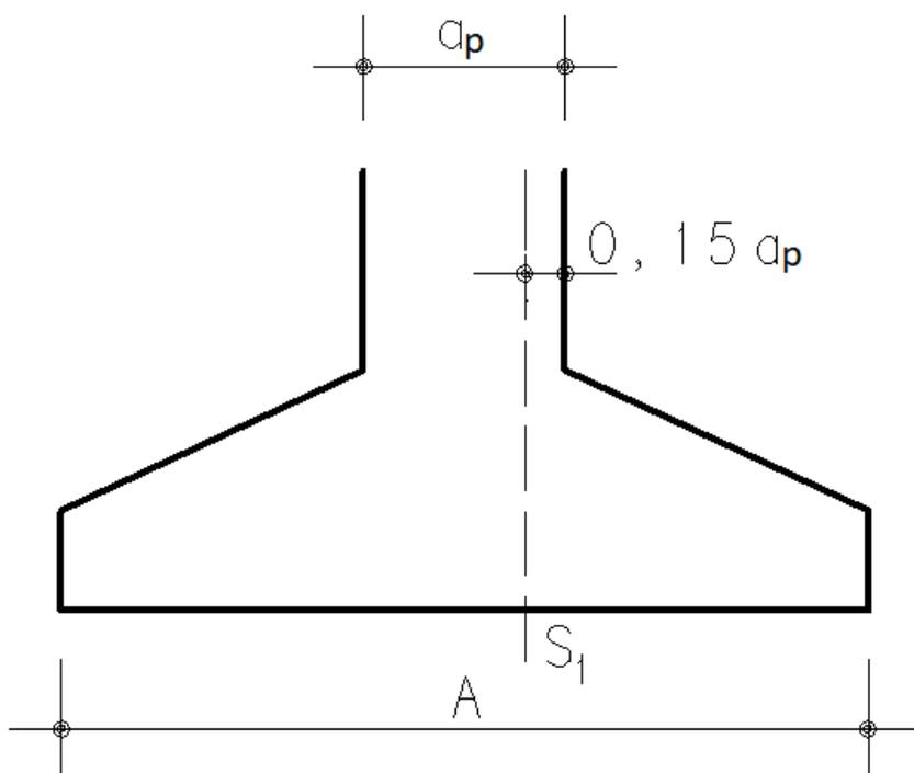
O momento fletor é calculado levando-se em conta o diagrama de tensões no solo, entre a seção  $S_1$  e a extremidade da sapata, ou seja, a sapata é dimensionada à flexão como uma viga em balanço.
