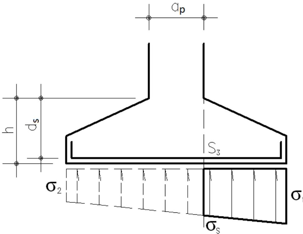
Existem quatro seções possíveis para o cálculo esforços cortantes: +X, -X, +Y e -Y, conforme apresentado a seguir:
