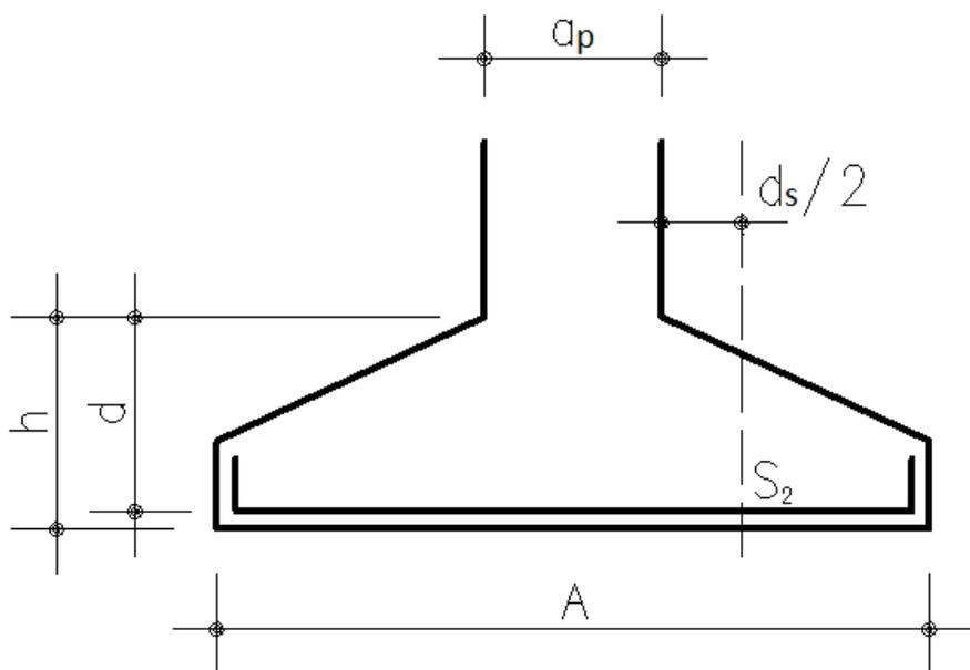
O esforço cortante é calculado levando-se em conta o diagrama de tensões no solo, entre a seção  $S_2$  e a extremidade da sapata, ou seja, a sapata é verificada ao esforço cortante como uma viga em balanço.
