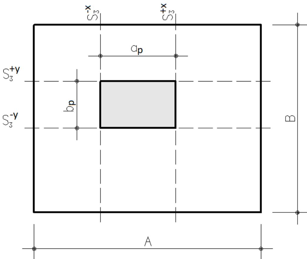
Pela integração numérica dos valores de tensão do solo pela área de cálculo é obtido o valor do esforço para cálculo da tensão cisalhante em cada uma das 4 seções. As áreas de cálculo utilizadas para cada seção são indicadas a seguir:
