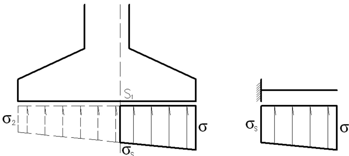
Existem quatro seções possíveis para o cálculo dos momentos fletores: +X, -X, +Y e -Y, conforme apresentado a seguir:
