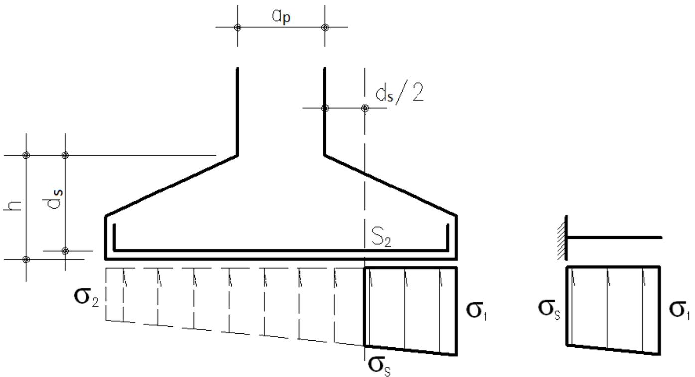
Existem quatro seções possíveis para o cálculo esforços cortantes: +X, -X, +Y e -Y, conforme apresentado a seguir:
