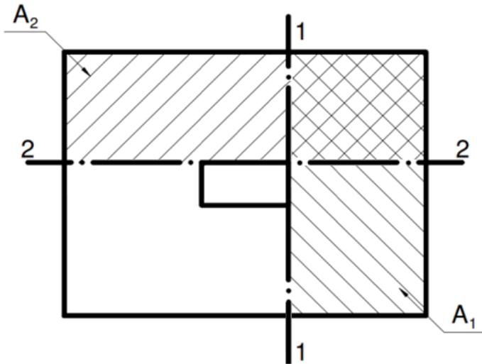
O momento fletor é calculado levando-se em conta o diagrama de tensões no solo, entre a seção  $S_1$  e a extremidade da sapata, ou seja, a sapata é dimensionada à flexão como uma viga em balanço.
