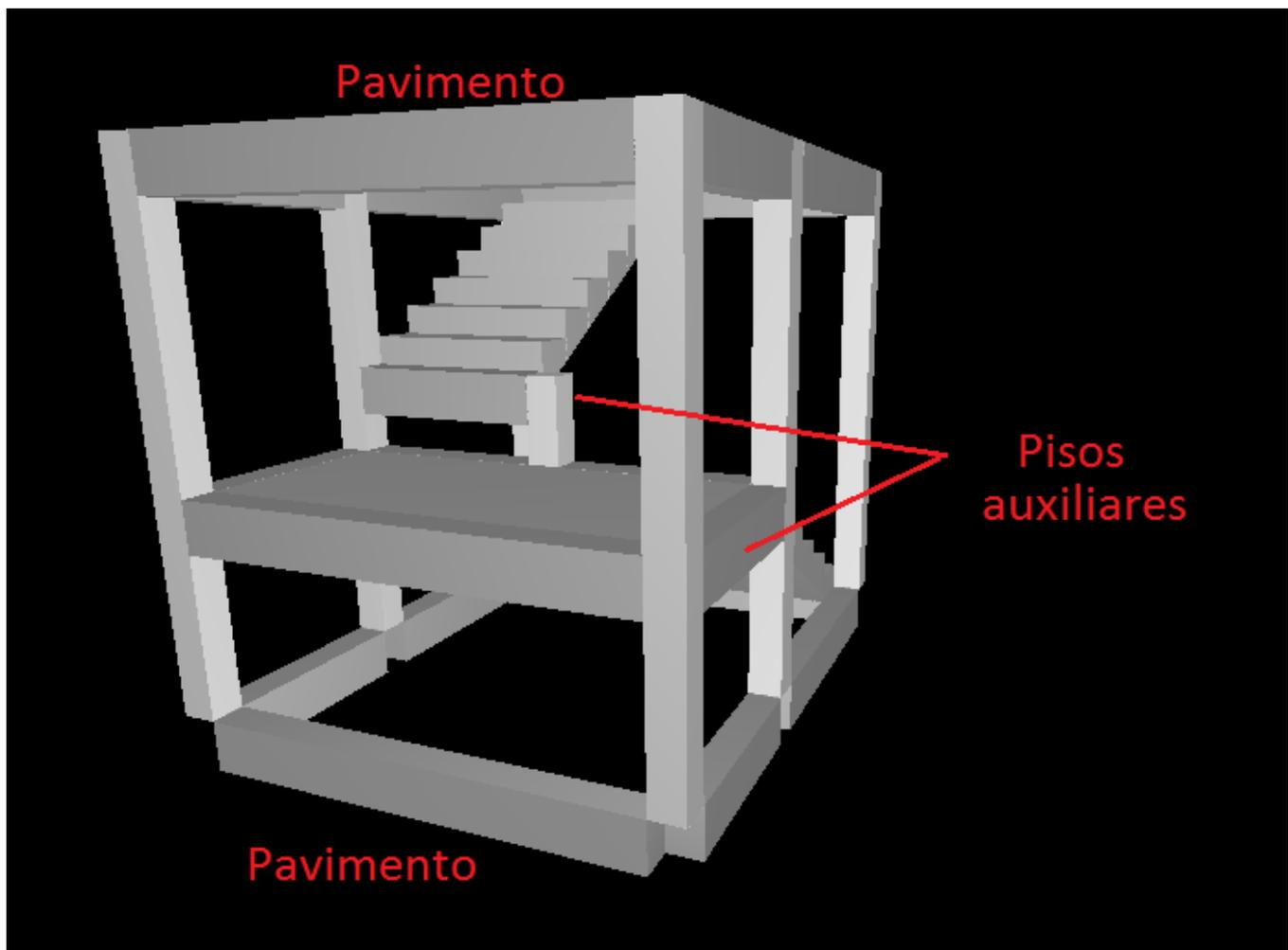
Não é possível lançar degraus “triangulares” no TQS. Tais degraus podem ser detalhados posteriormente como enchimentos.
