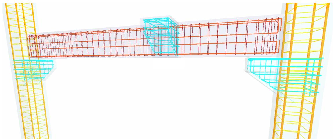
Após o detalhamento das vigas, é possível obter esta visualização selecionando a opção "Armaduras" - "Vigas" da janela "Geração de modelo tridimensional do edifício".
