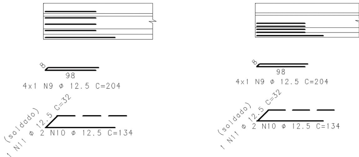
Para alterar este critério o usuário deve, no Gerenciador, ativar o "TQS-PREO" e executar "Editar" - "Critérios" - "Projeto" - "Detalhamento" - "Vigas" - "Extremos sem recorte". O critério "Disposição de costuras horizontais" controla a disposição destas armaduras.
