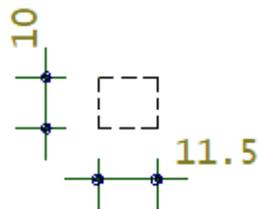
Geometria em planta do furo do bloco que recebe o graute vertical. (medidas em cm)
