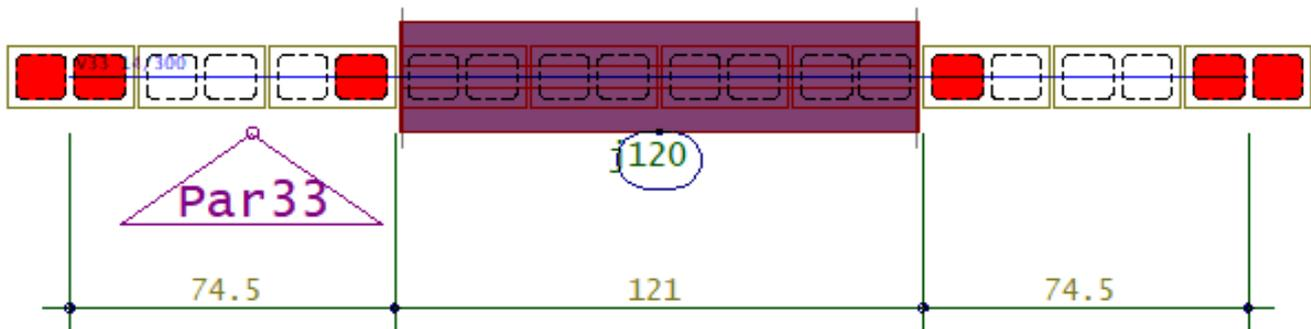
Geometria em planta da parede Par33. (medidas em cm)
