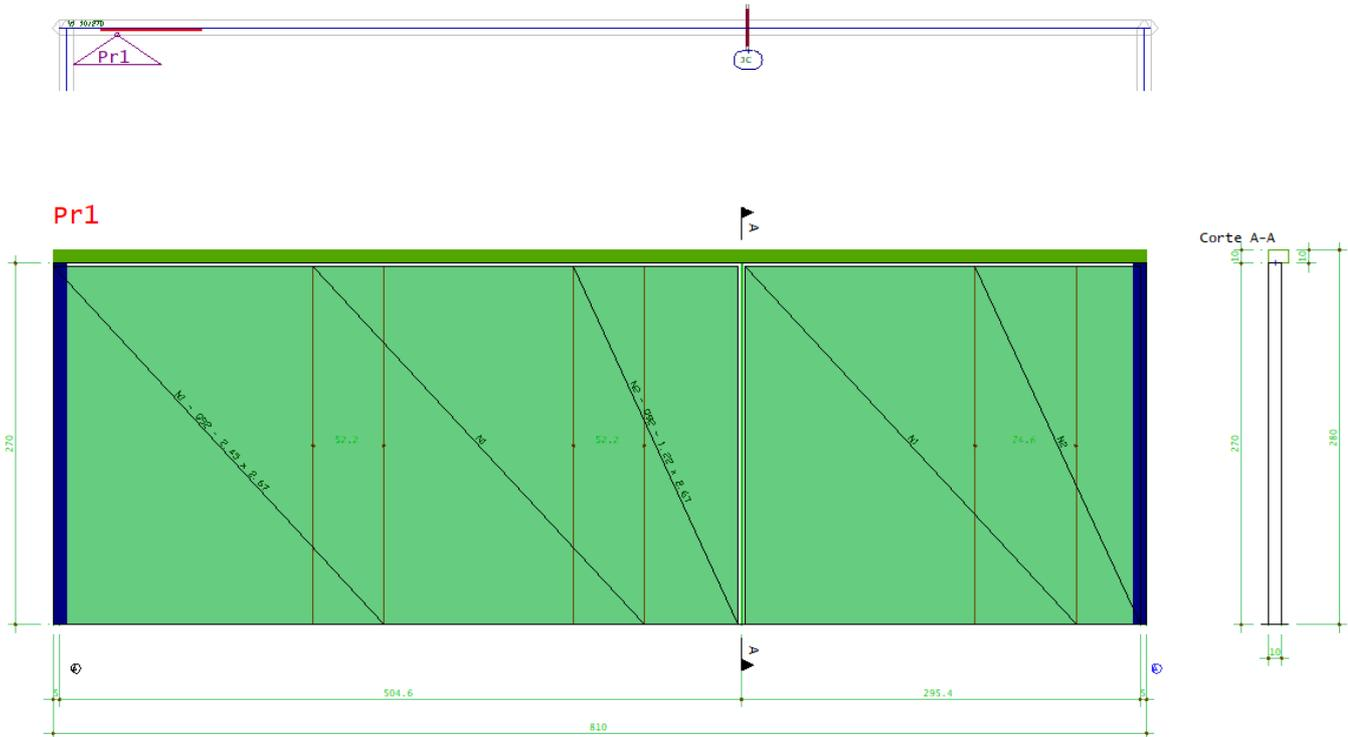
O resultado da junta será apresentado no detalhamento da parede com o corte da parede de concreto e o corte do detalhamento das telas soldadas.
