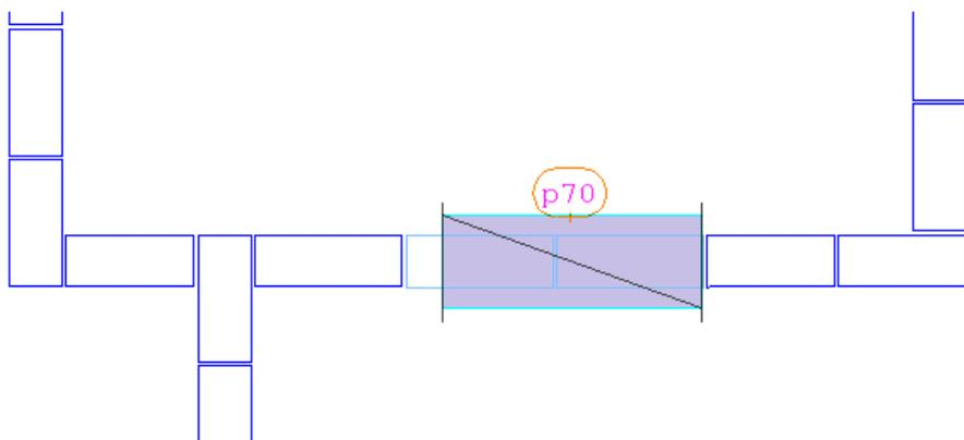
Através deste comando, apenas com a escolha de um bloco para representar a parede (clique em ①, por exemplo) e, em seguida, com a escolha, em qualquer ordem, dos blocos que a cruzam. Clique em ②, ③ e ④ e finalize com a tecla <Esc>:
