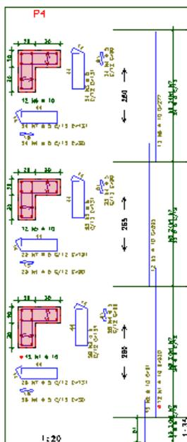
Podemos observar que uma janela do "Editor de armações genéricas" foi aberta. Como já foi apresentado anteriormente, este é um editor genérico de desenho de armação de concreto armado. Nele é possível fazer qualquer tipo de alteração no desenho, possibilitando a alterações dos cortes da seção transversal, criação de novas armaduras, alteração dos textos, etc.
