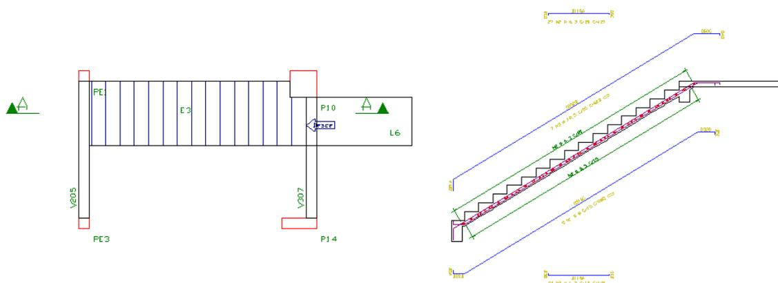
Nos desenhos de detalhamento de escadas sempre serão representados em planta os elementos de apoio da escada, os lances, os patamares e parte das lajes onde as armaduras ancoram.
