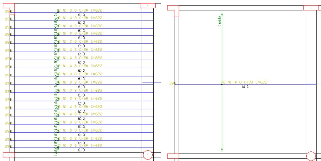
Após a edição das faixas de distribuição de esforços, o detalhamento de armaduras é automático, considerando os critérios fixados pelo engenheiro. As armaduras geradas dentro do editor podem ser editadas antes do desenho final ser gravado.
