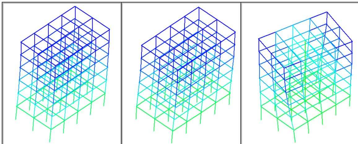
Nesse visualizador, além de se poder analisar graficamente os modos de vibração da estrutura, para cada caso de sismo definido, pode-se acessar os seguintes resultados: "Aceleração e amplitude modal" e "Reações na base".
