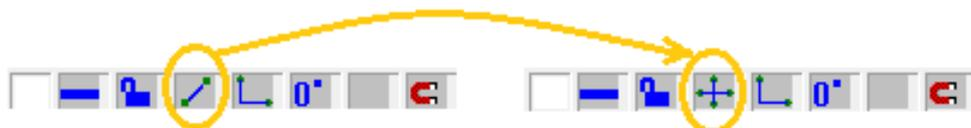
Podemos escolher entre inserir as paredes com no modo 2D com uma vista em planta ou no modo 3D com uma vista espacial, note que ao concluir o comando de inserção da primeira parede os cruzamentos serão automaticamente reconhecidos.
