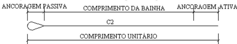
Ilustração referente a um cabo onde há ancoragem intermediária.
