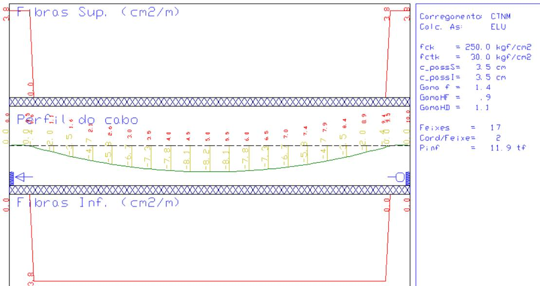
Neste "Modo de Edição" podemos observar qual a armadura passiva complementar necessária para as lajes em que estamos trabalhando.
