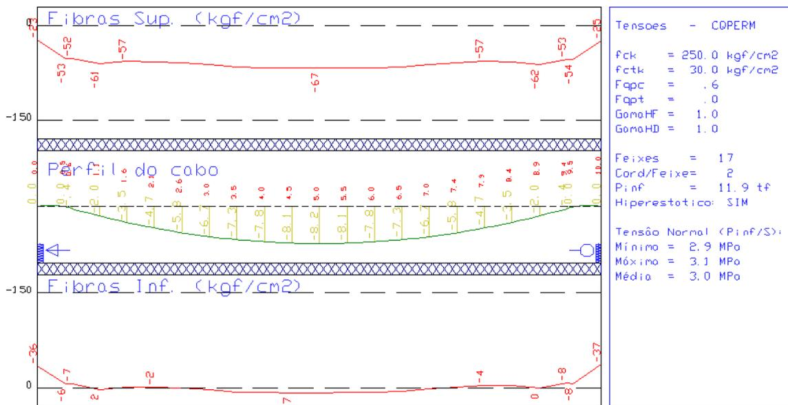
Podemos observar que uma série de pontos, nas fibras inferiores da laje, ultrapassa o limite. Para resolvermos este problema, vamos, mais uma vez aumentar a quantidade de cabos.
