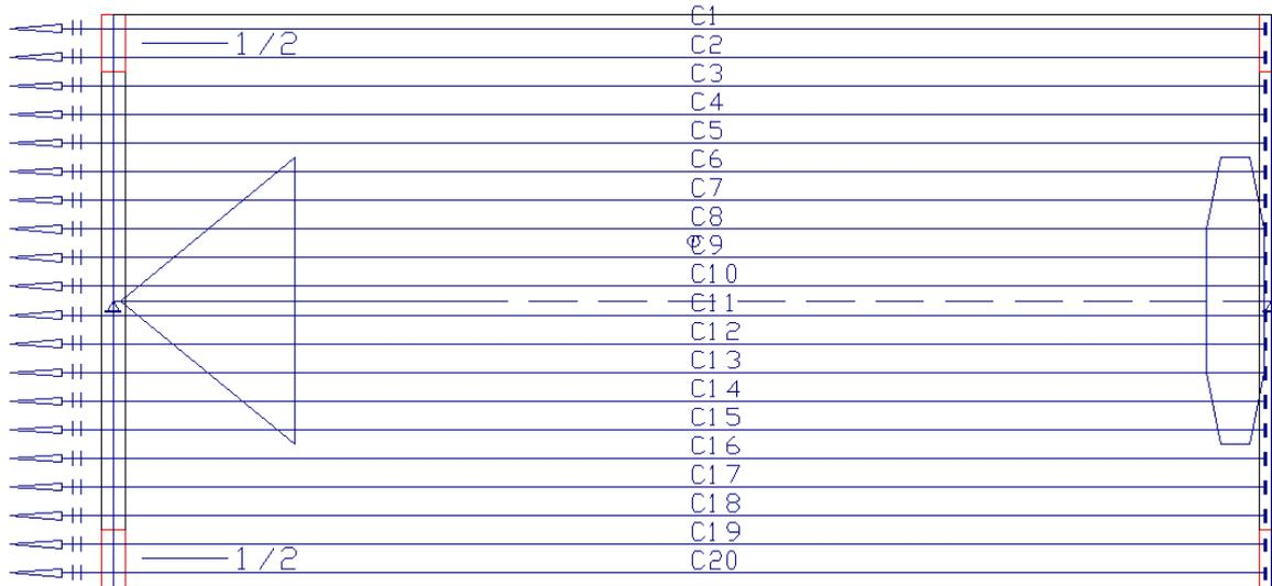
Neste desenho podemos observar o posicionamento, em planta, de todos os cabos que serão utilizados nesta laje. Ferramentas para edição destas posições, alteração de dados ou ancoragens e outros podem ser encontradas na barra de ferramentas. Estas ferramentas são explicadas com detalhes nos capítulos iniciais deste manual.
