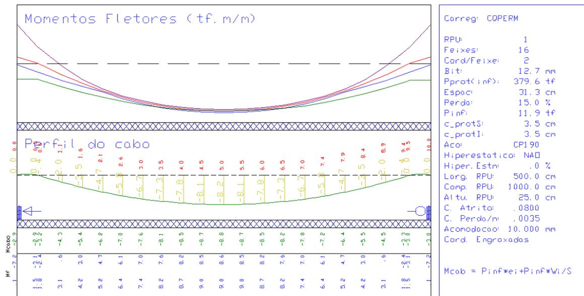
No quadro lateral, onde temos informações sobre o dimensionamento, podemos observar que foram utilizados 16 cabos de 2 cordoalhas de 12,7 mm como armadura de protensão para esta laje.
