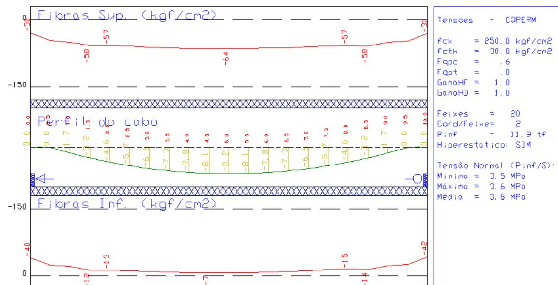
Observe que os valores de tensões tiveram uma leve mudança, devido à diferença entre o hiperestático calculado com o modelo de grelha do pavimento e o calculado com o modelo único.
