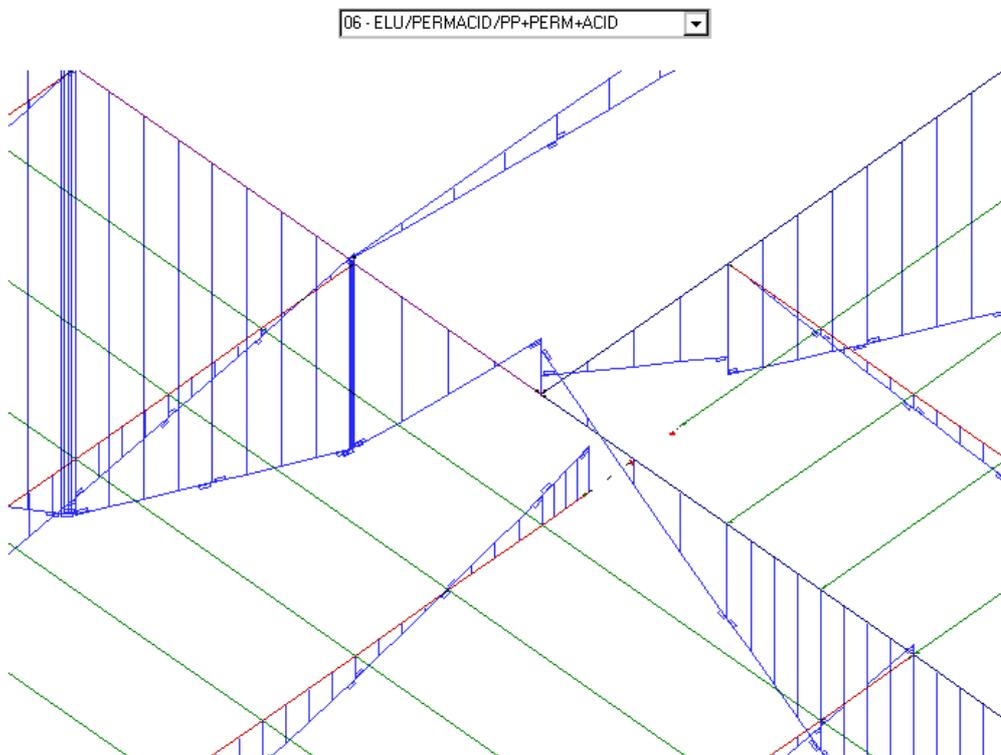
Nesta combinação, que é formada pela "soma" dos três diagramas apresentados anteriormente, podemos observar a presença de momentos negativos nas vigas e extremidade de algumas barras das lajes. Ou seja, as lajes serão dimensionadas levando-se em conta estes valores de esforços solicitantes.
