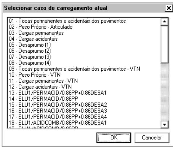
Na figura acima também podemos observar algumas das combinações de carregamento existente no modelo. Nelas, para esta etapa construtiva só são utilizados os casos de peso próprio e de desaprumo.
