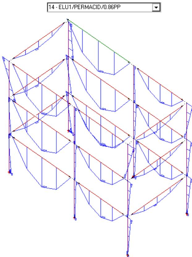
Ou seja, percebemos que, para esta etapa construtiva, temos apenas diagramas "isostáticos" nas vigas. Nos pilares, os momentos aparecem devido à excentricidade do apoio das vigas, que é feito através de consolos.
