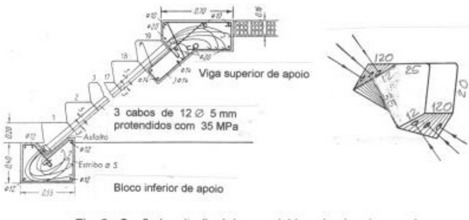
Fig. 5 - Seção longitudinal desenvolvida pelo eixo da escada helicoidal da Fig. 4. No detalhe um dos degraus em perspectiva, mostrando as posições dos 3 cabos [1].
