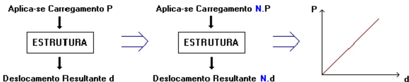
Note que para qualquer carregamento N.P o deslocamento resultante N.d será sempre proporcional. Isto é uma consideração básica adotada em qualquer programa de análise estrutural.
