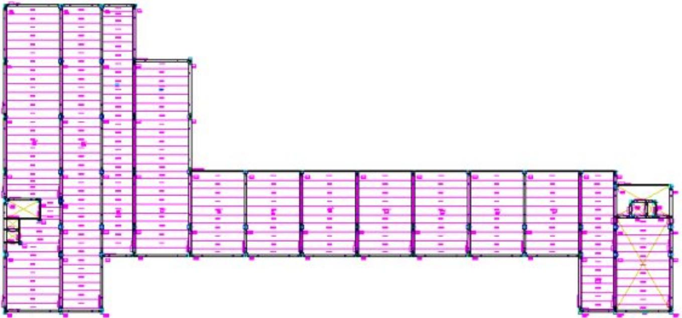
Este é um típico edifício pré-moldado de múltiplos pavimentos: travamento de vigas em uma direção e lajes alveolares na outra direção.
