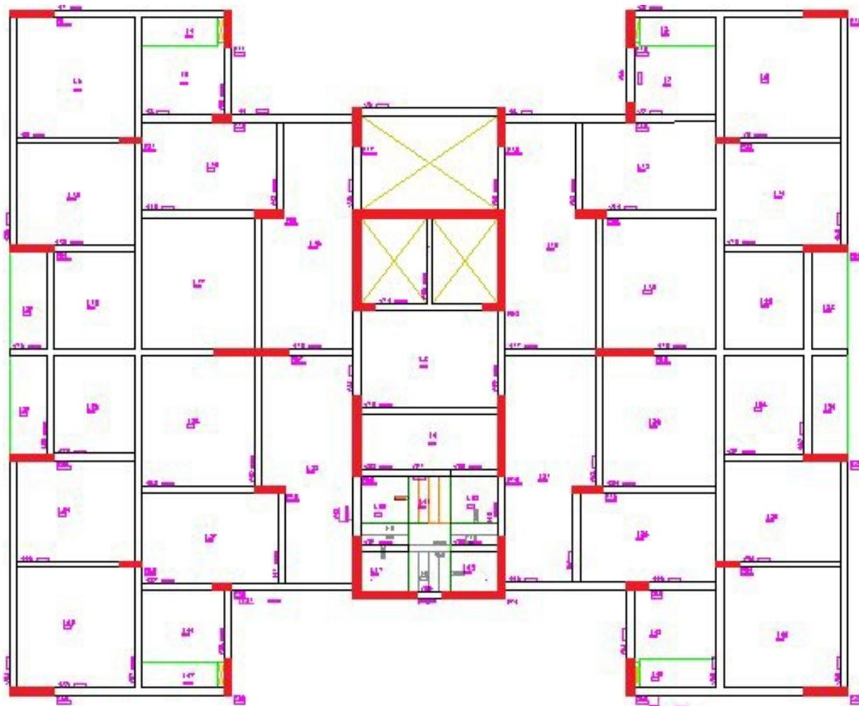
Podemos observar que neste edifício temos vigas em ambas as direções, sendo que muitas delas formam pórticos em ambas as direções. A altura média das vigas é de 50 cm e a altura das lajes é de 9 cm. Considerando estes dados observados, poderíamos dizer que a laje influi pouco no comportamento global da estrutura. Ou seja, rodar este edifício com Modelo 4 ou Modelo 6 geraria resultados muito próximos.
