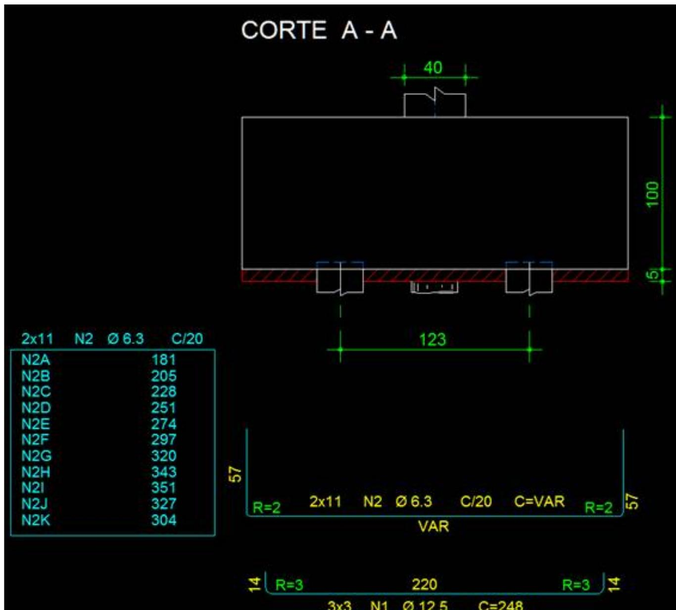
Vamos agora duplicar o ferro e colocar acima deste. Para isso, iremos utilizar o comando “Duplicar linha” na barra de ferramentas “Linhas de ferro”, colocar na posição desejada e inverter a pata, clicando duas vezes no ferro e indo na aba “Linha”:
