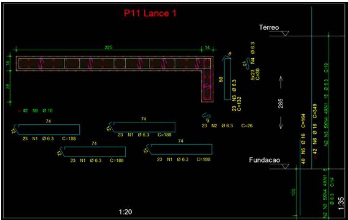
O primeiro passo será apagar o estribo horizontal e acionar a barra de ferramentas “Estribos e grampos”:
