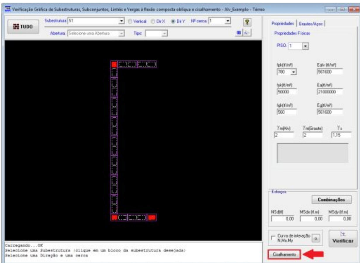
Figura 12 – Acessando a Calculadora para verificação de Cisalhamento.
