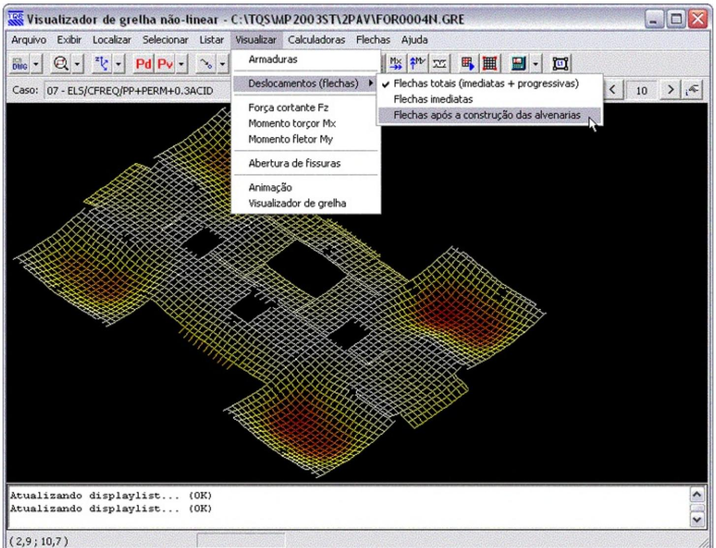
b) Visualização de curvas de isovalores de deslocamentos com gradiente de cores.
