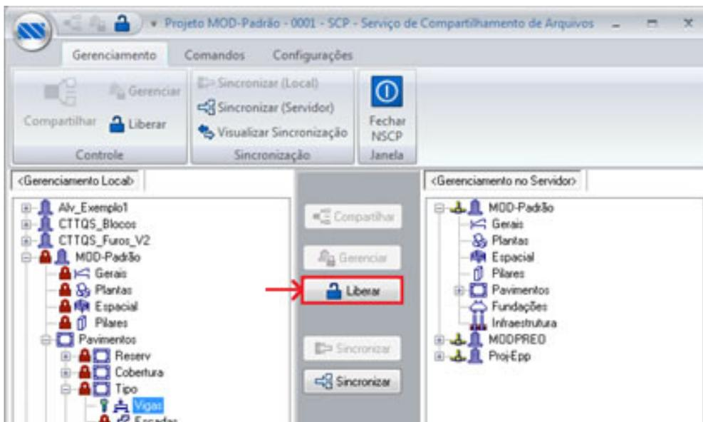
Ao fazer isso, você irá devolver para o servidor, o projeto de vigas do pavimento tipo atualizado.
