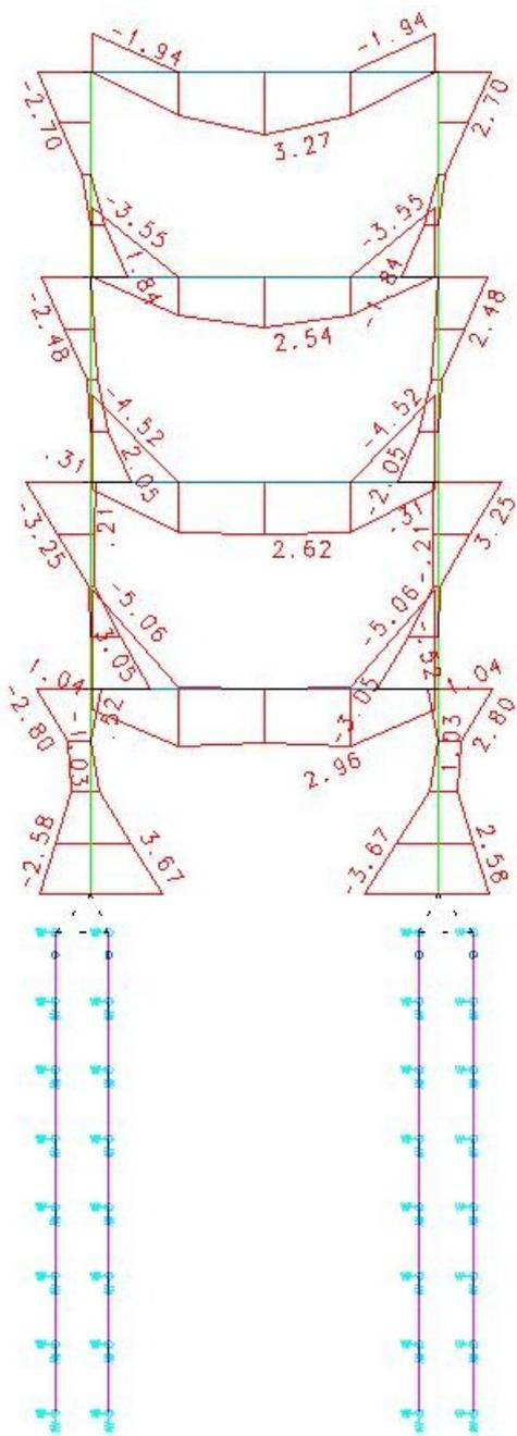
Podemos observar que os momentos fletores nas estacas desapareceram. A força horizontal que aparece na base do pilar da estrutura é absorvida no topo da estaca na sua totalidade. A estaca agora não necessita mais de armação pois ela não apresenta nenhum ponto de tração ao longo da sua extensão.
