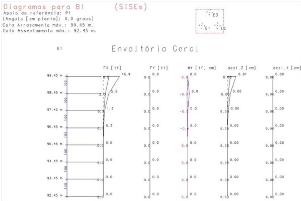
**Detalhe de desenho, gerado pelo SISEs, com os resultados (esforços e deslocamentos) principais em uma estaca.**
