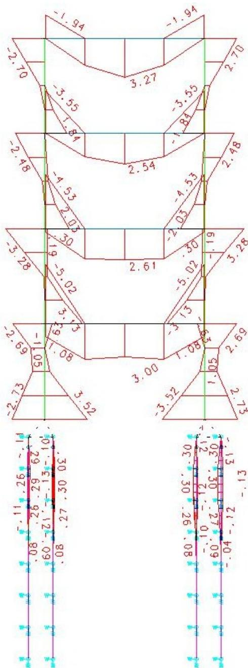
Como se pode notar pelo diagrama acima, as estacas ainda estão submetidas a esforços de flexão. O valor máximo do momento fletor foi de 30.2 tf\*cm a 1 m de profundidade. Na seção transversal da estaca a esta profundidade, temos ainda tensões de tração na borda da estaca. A estaca também necessita ser armada até uma determinada profundidade.
