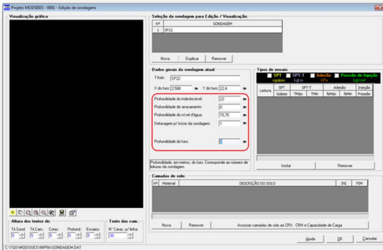
**Tipos ensaio:** existem 4 tipos de ensaio: SPT, SPT-T, Adesão e Pressão.
