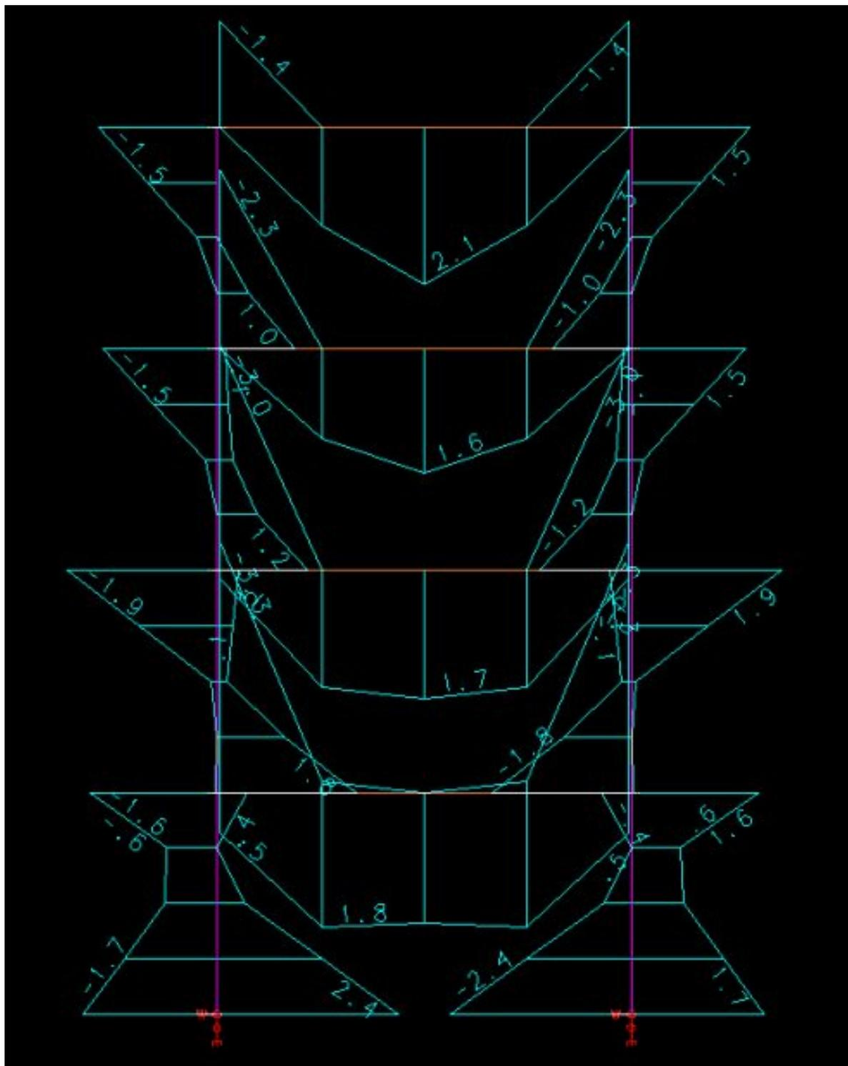
Detalhe da envoltória dos momentos  $M_y$  (base dos pilares e 1º lance), considerando o pórtico da estrutura com “engastamentos perfeitos”.
