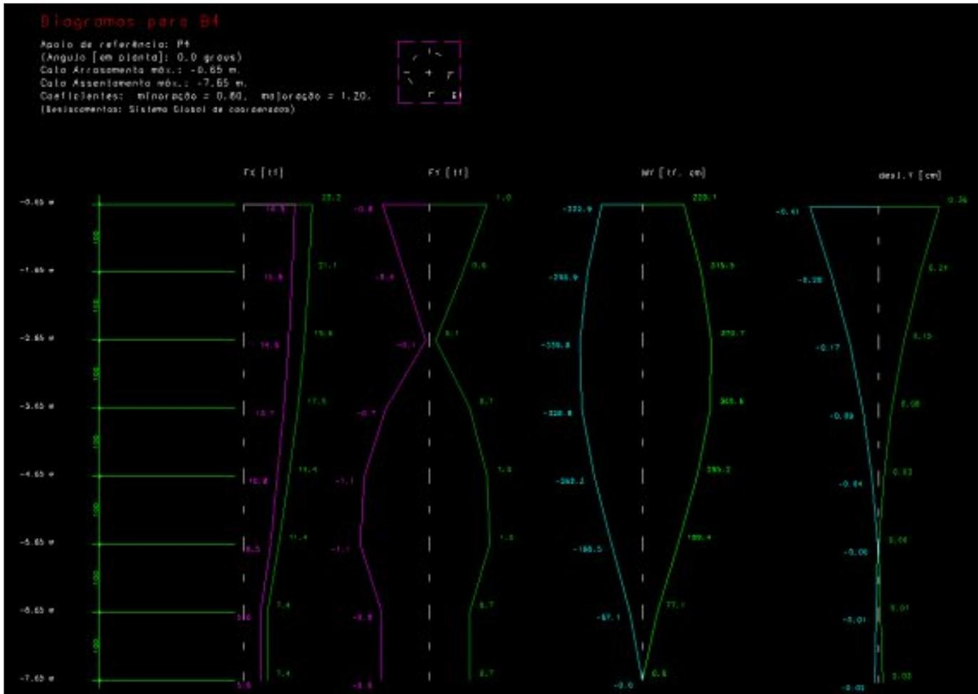
Observe pelo diagrama acima que o momento fletor máximo na estaca não está no topo e sim num ponto intermediário, igual a 370.7 tf\*cm. Sob o ponto de vista do concreto, a estaca passou, armada. Com esta magnitude de momentos fletora estaca tem regiões de tração. Sob o ponto de vista do solo, a capacidade de carga da estaca atendeu plenamente.
