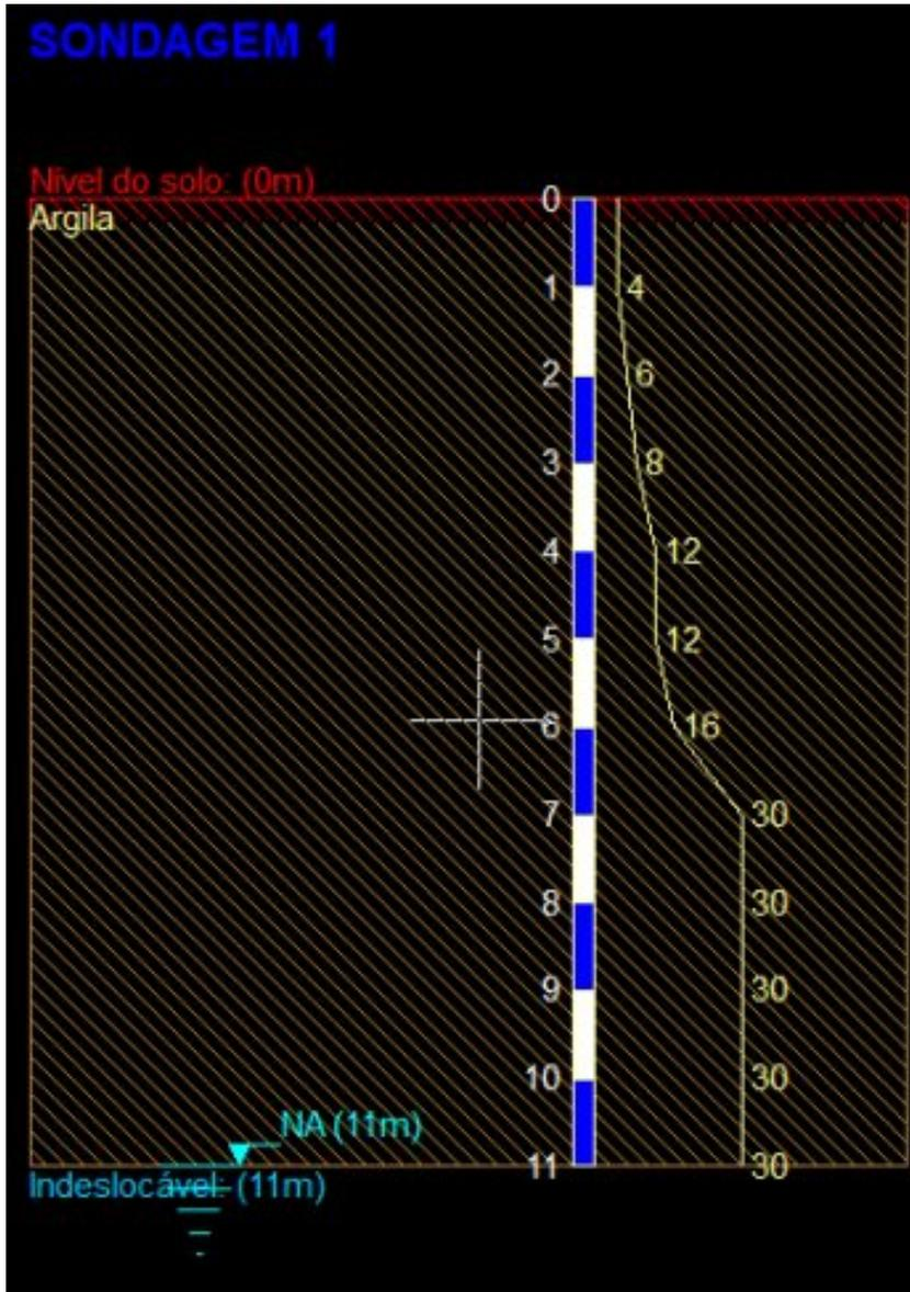
Estaca: tipo hélice contínua, tensão admissível de 40kgf/cm<sup>2</sup>, fator de segurança 2 e comprimento da estaca de 7m.
