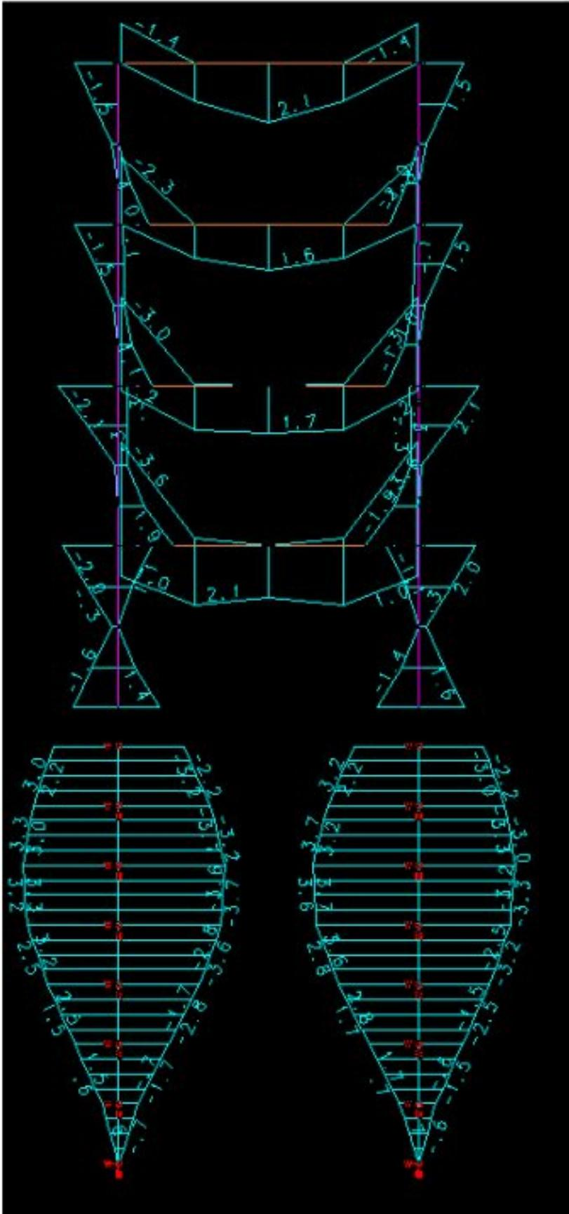
Deve-se notar que o momento fletor na estaca foi maior do que no pilar. Sem a colaboração da estaca a flexão, a estrutura não fica estável. As armaduras dos pilares devem ter emendas com as armaduras das estacas. Não estamos estudando ainda os efeitos de segunda ordem do conjunto pilar + única estaca.
