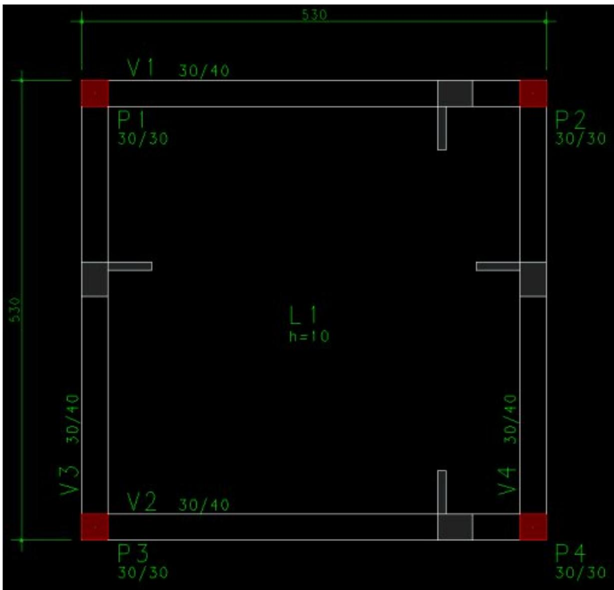
Cargas consideradas na laje: 0,1tf/m<sup>2</sup> de carga permanente e 0,15tf/m<sup>2</sup> de carga acidental.
