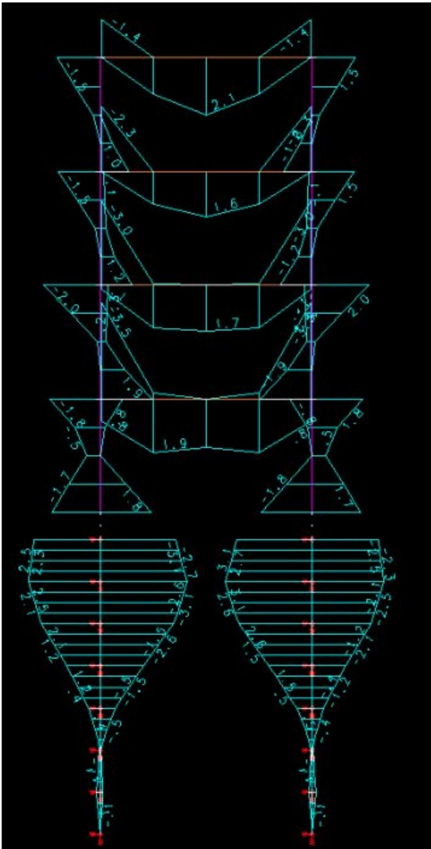
A primeira observação a ser feita é que o aumento do vínculo elástico horizontal em 10 vezes não alterou significativamente os resultados de momentos fletores. Com o maior engastamento da estaca no solo, os momentos fletores na estaca se reduziram. Mesmo assim é necessária a armação nas estacas. Os momentos fletores na base do pilar aumentaram.
