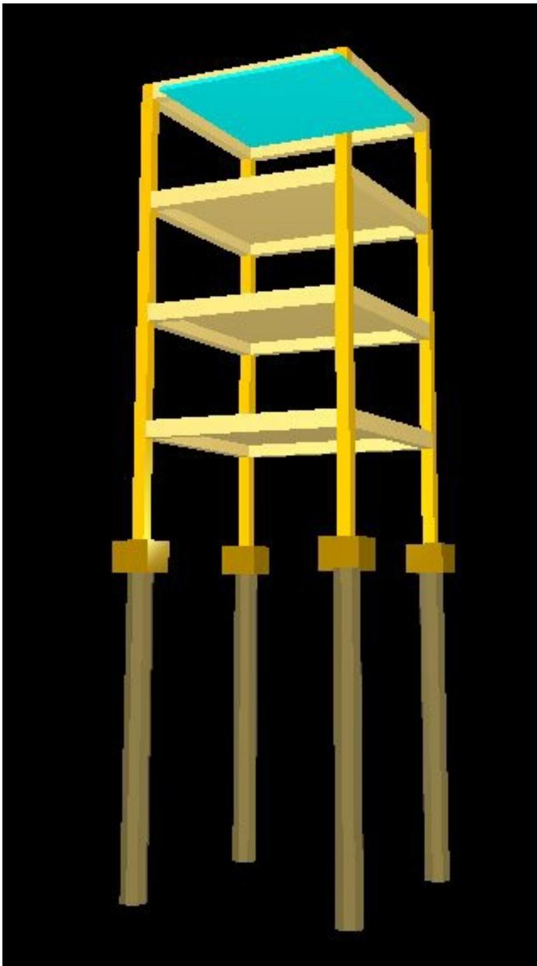
O pórtico espacial resultante, para este caso, será como o que segue abaixo, onde se observa a infra-estrutura discretizada e agregada à superestrutura (através de novos nós e vínculos elásticos), formando-se então um novo pórtico espacial – um modelo integrado e único – com a presença do efeito do solo:
