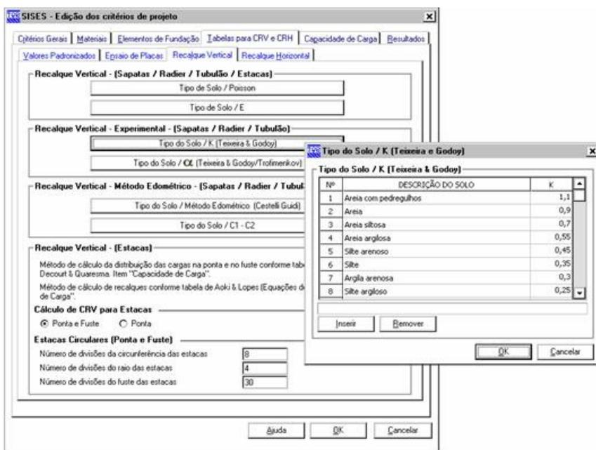
Detalhe de informações para cálculo do Recalque Vertical
