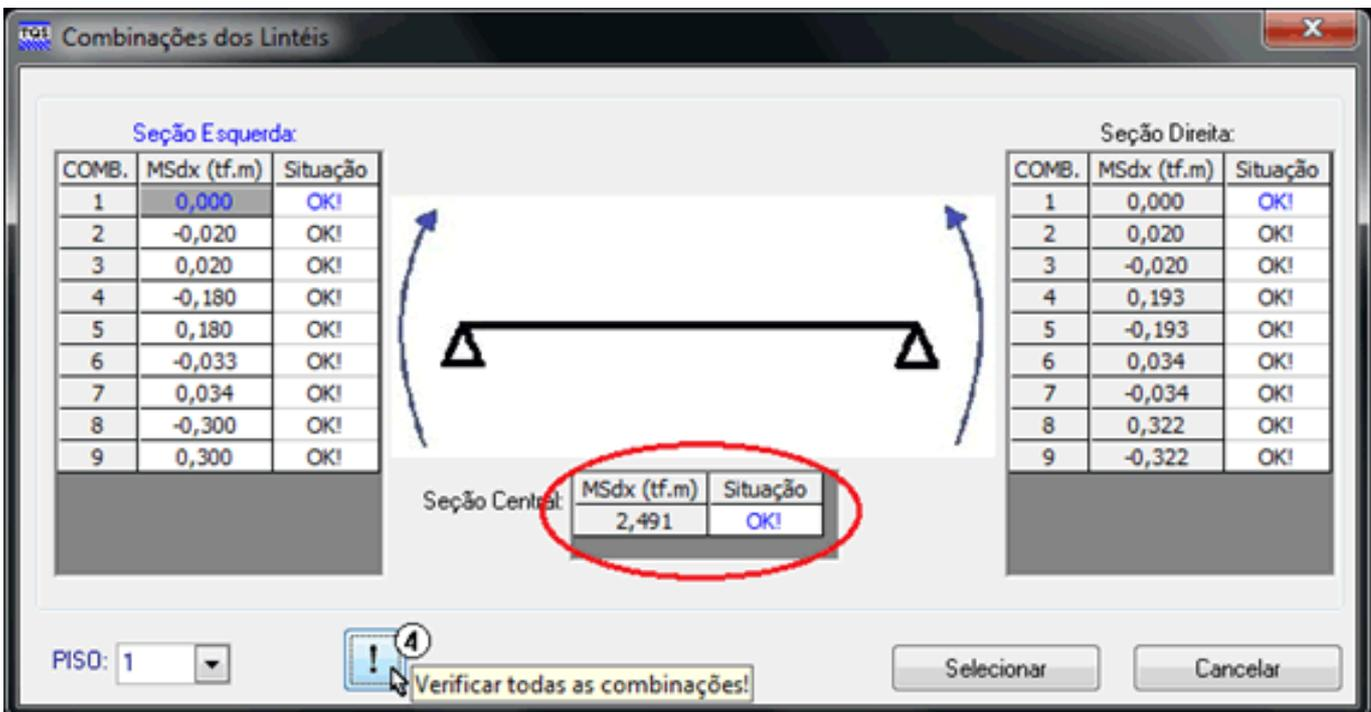
Como o lintel passou com as duas barras de  $f_i=10\text{mm}$ , vamos agora analisar apenas a verga isolada. Para isso, voltamos a calculadora, (1) para selecionamos a opção de verga e novamente acionamos o botão “combinções”.
