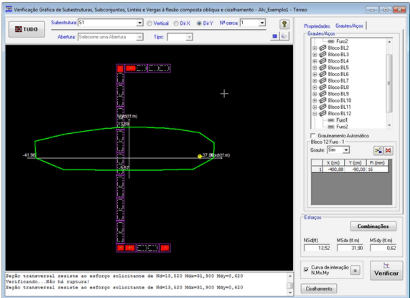
É bom lembrar que quando há a adição de novos grautes, a inércia da seção da parede se modifica e um reprocessamento do edifício é necessário para a obtenção de novas solicitações e convergência da solução.
