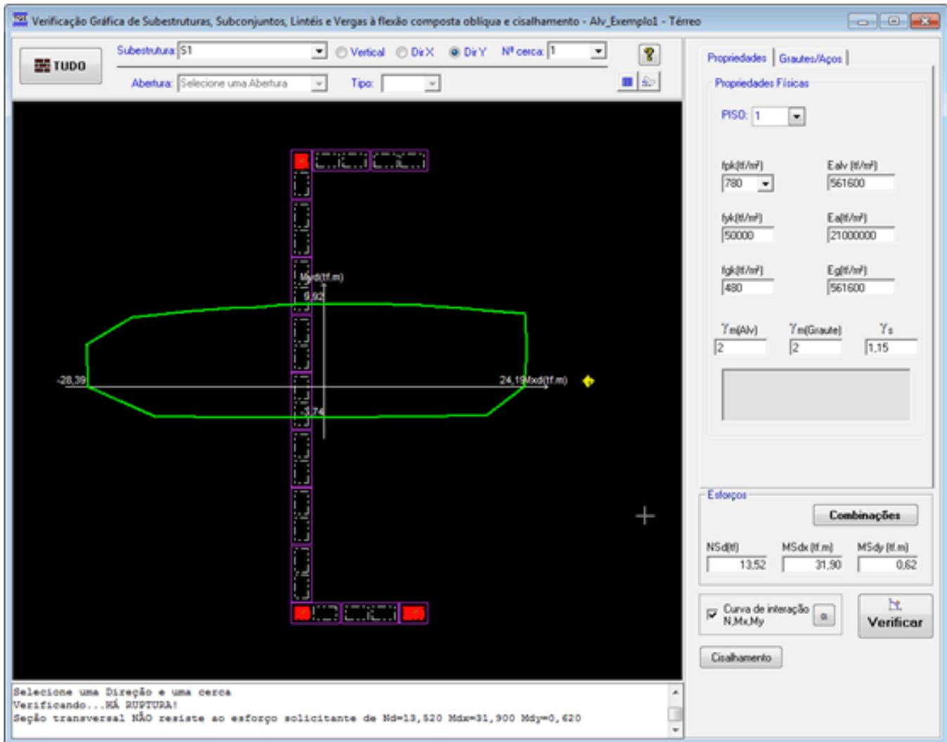
Com os resultados obtidos, pode-se observar, no gráfico acima, que o caso de carregamento selecionado resulta num ponto no exterior da curva de interação, então, concluímos que o trecho de parede verificado “não passa”.
