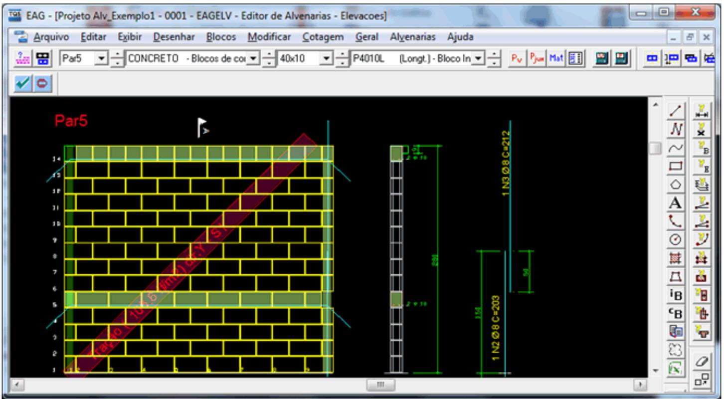
Para definir um posicionamento de armaduras que resista às solicitações de tração, pode-se usar a calculadora de paredes de alvenaria, que realiza verificações de seções submetidas a esforços de flexão composta oblíqua, disponível no Alvest.
