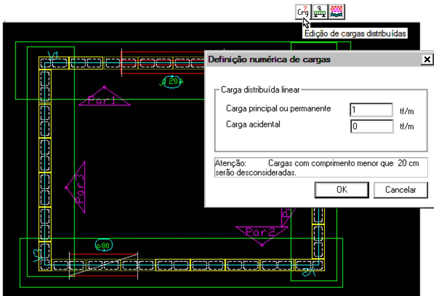
No detalhe temos a carga distribuída exatamente sobre a linha de carga da parede de alvenaria estrutural:
