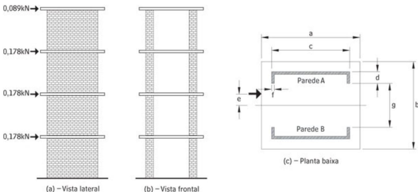
Figura 2 - Modelo reduzido ensaiado por U. C. KALITA and A. W. HENDRY (1970)
