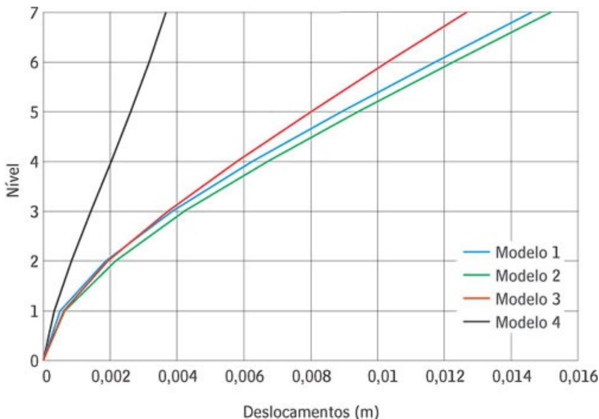
Figura 6 - Deslocamentos horizontais ao nível dos pavimentos
