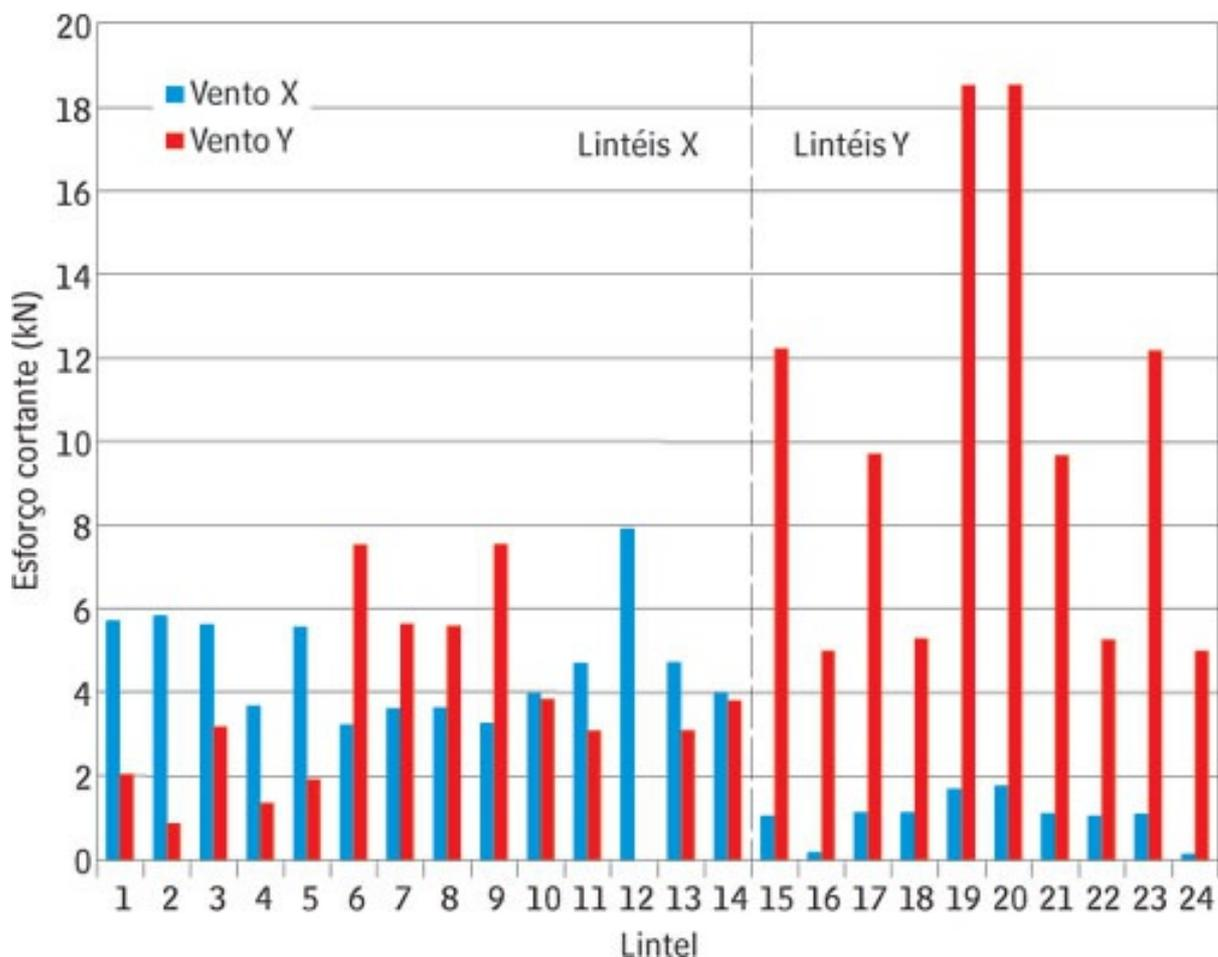
Figura 9 - Esforços cortantes máximos nos lintéis
