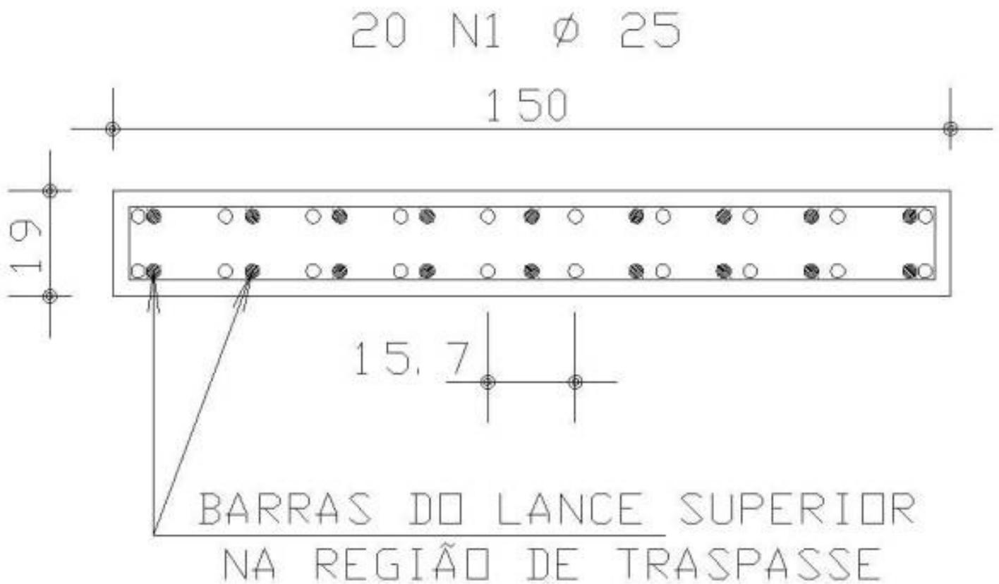
A NBR6118 permite taxas de até 8% para o total de armaduras (lance+emendas no traspasse) e tenho observado em projetos, detalhamento com 5% de armaduras no lance, passando, em alguns casos, de 8% na região de traspasse.
