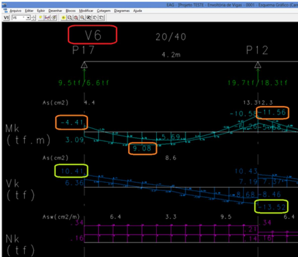
Através da função de "Equivalência de Vigas", vamos igualar as vigas analisadas com a **Viga Mestre**, para que não sejam utilizadas. Em "Editar", siga a sequência abaixo:
