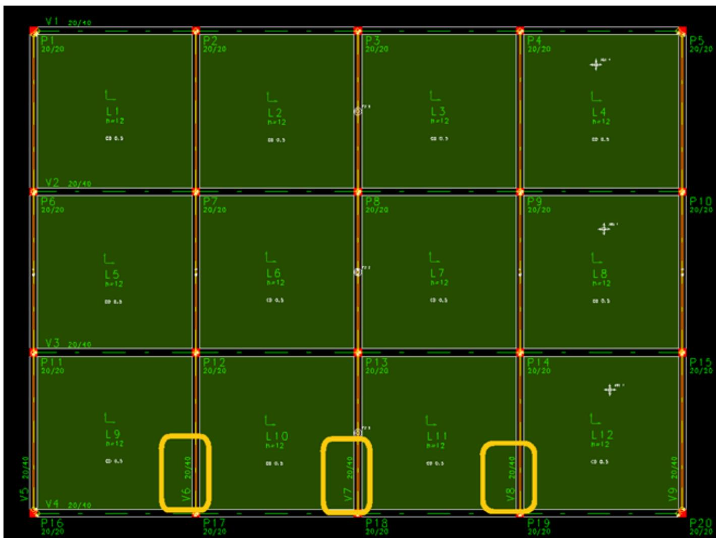
Após o Processamento Global do edifício, no TQS-Vigas veja as envoltórias de esforços diferentes para cada viga. Aqui temos uma comparação de esforços diferentes entre as vigas V6 e V8:
