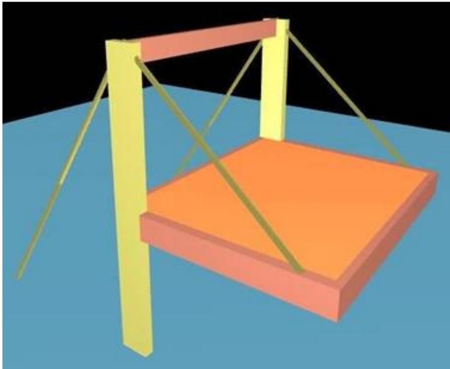
É um pórtico simples, com tirantes sustentando a laje e outros na parte de trás, estabilizando a estrutura.
