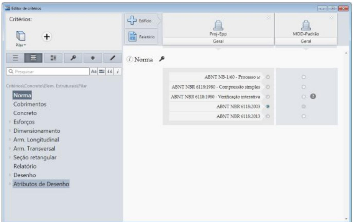
Figura 9 – Alteração de critérios de edifícios diferentes simultaneamente
