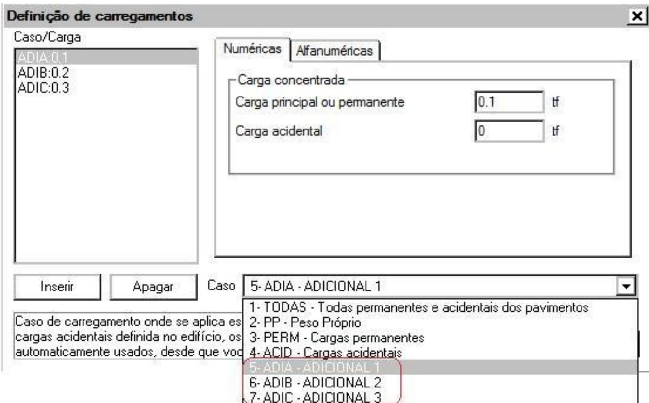
Em seguida clique em 'ok' e insira a carga concentrada no topo do pilar.
