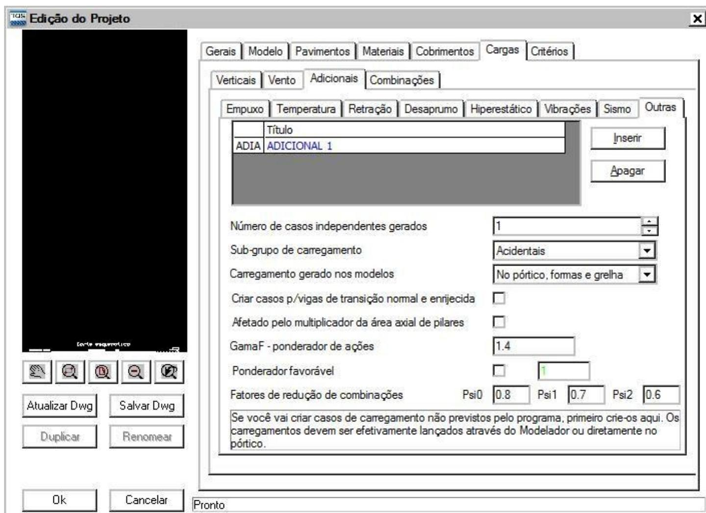
Para realizar a inserção de novas cargas adicionais, clique em 'Inserir' e em seguida digite o nome do novo carregamento, conforme mostra a figura a seguir:
