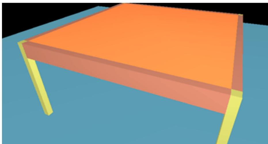
Figura 1 – Exemplo de torção de compatibilidade
