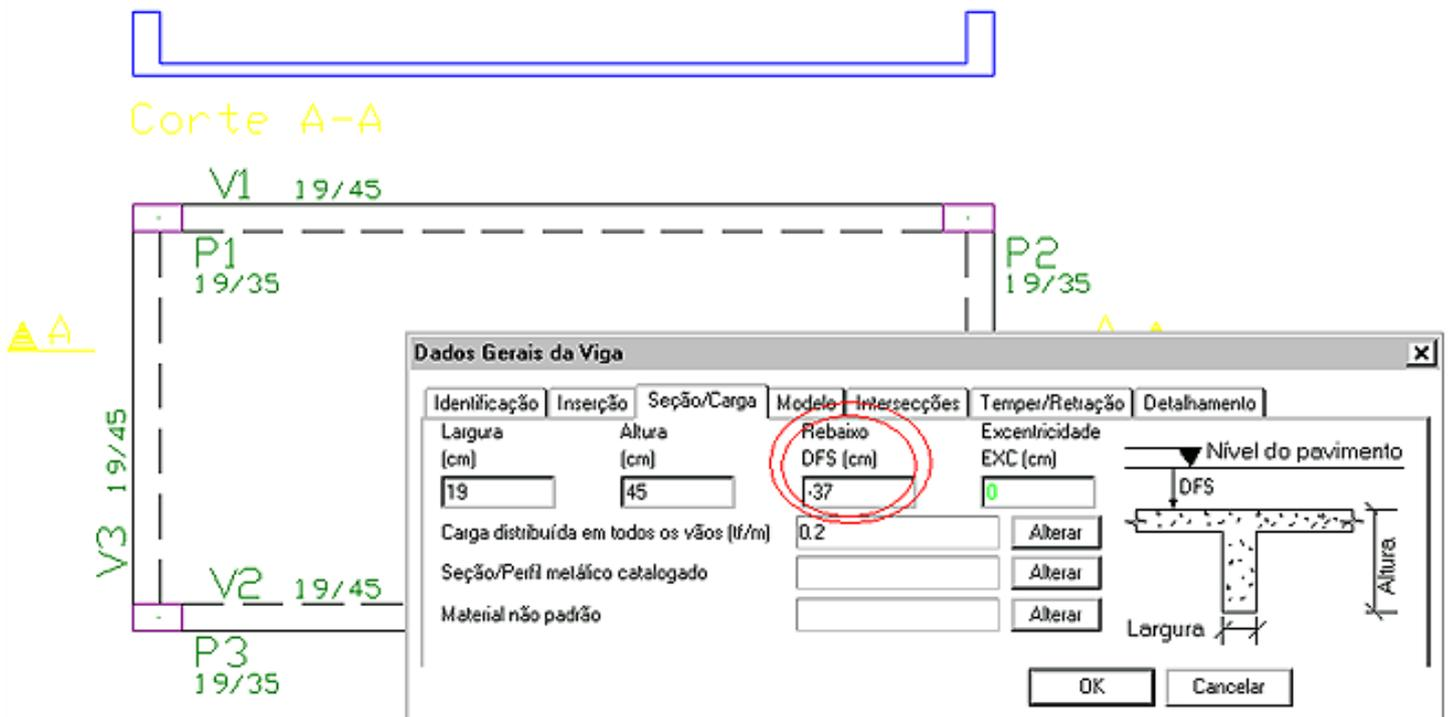
No pavimento baldrame, defini as vigas apoiando juntamente com os pilares em blocos sobre duas estacas e para reduzir o vão entre apoios, para as vigas V1 e V2 defini um Tubulão, simulando uma estaca servindo de apoio direto para estas vigas.
