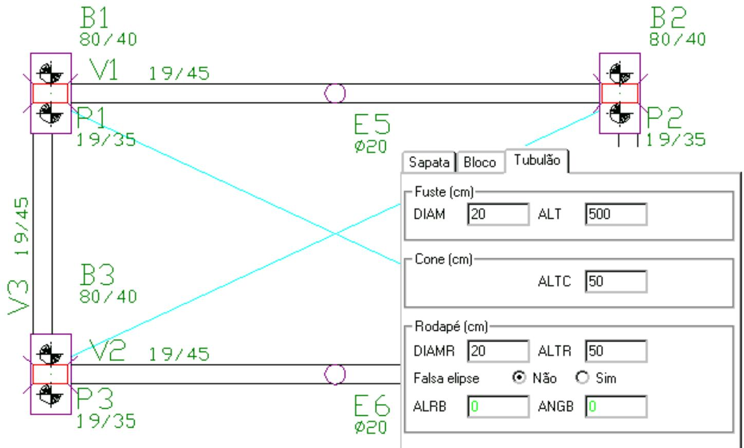
Atualmente os Sistemas TQS, não dimensionará estas estacas, o resultado prático para este tipo de definição é apenas a criação de apoio para as vigas V1 e V2, sendo que este apoio será levado em consideração no modelo estrutural e implicará diretamente nos resultados do dimensionamento destas vigas.
