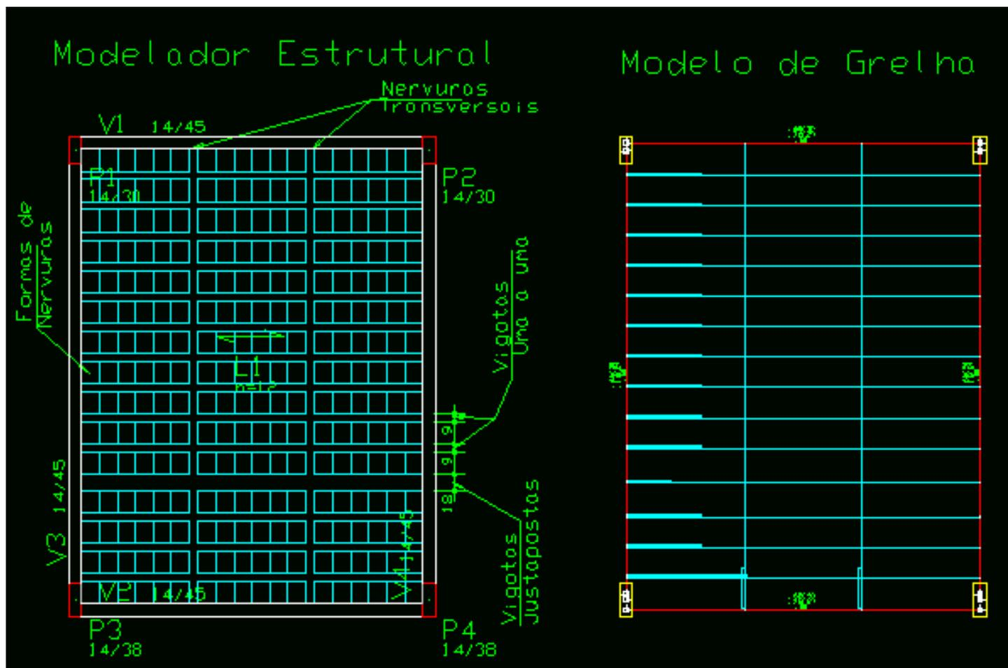
O detalhamento automático irá dimensionar a "Vigota justaposta como uma vigota maciça de concreto", será necessário verificar a equivalência da armadura detalhada com a armadura correspondente a duas vigotas justapostas, com a verificação OK! Salve o DWG e edite manualmente ajustando o detalhamento:
