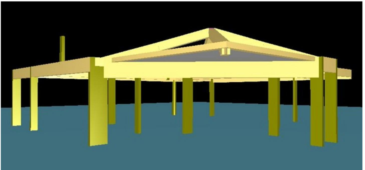
Na realidade, o sistema que ele pretendia formar é composto por vigas inclinadas "segurando" uma laje em balanço, com viga V10 transversal ao balanço ligando os pilares P37 e P42. Como poderemos observar nos diagramas abaixo do pórtico espacial, esta região se mostram bastante estável.
