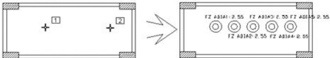
Comando: Gerar carga móvel Ponto inicial da carga móvel : <B1> no PT1 Ponto final da carga móvel : <B1> no PT2
