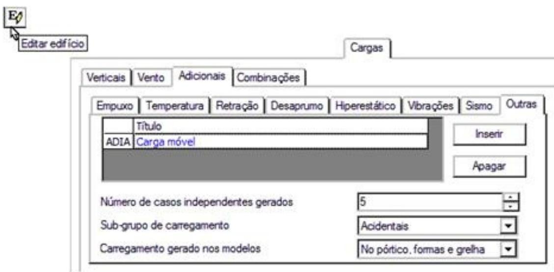
Note na ilustração acima os dados do edifício foi editado e após acionar a guia "Cargas" foi escolhida a opção "Outras", então foi inserido um caso adicional, chamado de "Carga móvel" e criado 5 casos independentes, significando que a carga móvel sofrerá cinco variações de posição dentro do limite que será estabelecido no Modelador Estrutural.
