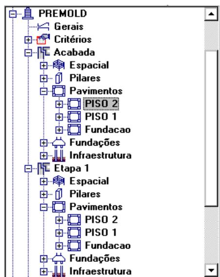
Ao abrir os ramos do edifício, vemos que sob cada etapa construtiva e sob a estrutura ACABADA estão todos os outros ramos correspondentes aos pavimentos, vigas, pilares, fundações e infra-estrutura. Cada "Etapa" se comporta como um edifício completamente independente, com seus pórticos e grelhas, podendo ser feito o processamento do dimensionamento, detalhamento e desenho de uma etapa completa.
