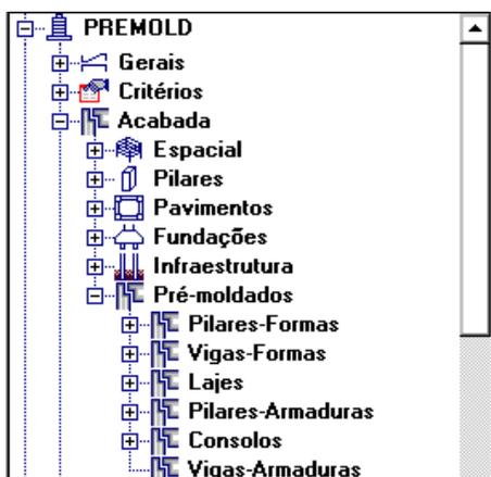
Sob o ramo da estrutura acabada, temos ainda uma pasta "Pré-moldados", com as sub-pastas para desenho de formas e armação de vigas, pilares, lajes e consolos. Os programas de dimensionamento, detalhamento e desenho
