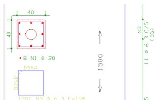
Na saída da tubulação, entretanto, o programa não verifica a redução da seção do pilar, nem detalha o reforço de armadura, que deve ser feito manualmente.
