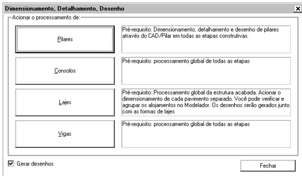
O dimensionamento, detalhamento e desenho de pilares são feitos com auxílio do TQS-Pilar. Para processar é necessário:
